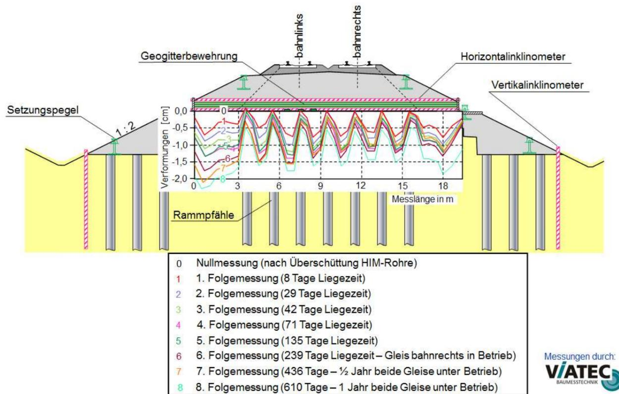
Bild 10: gemessene Verformungen eines Horizontalinklinometers über den Pfählen nach 610 Tagen an einem ausgewählten Querschnitt
