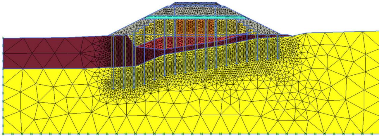
Bild 4: Gebrauchstauglichkeitsuntersuchungen der SGP-Bauweise mittels FE-Berechnungen
