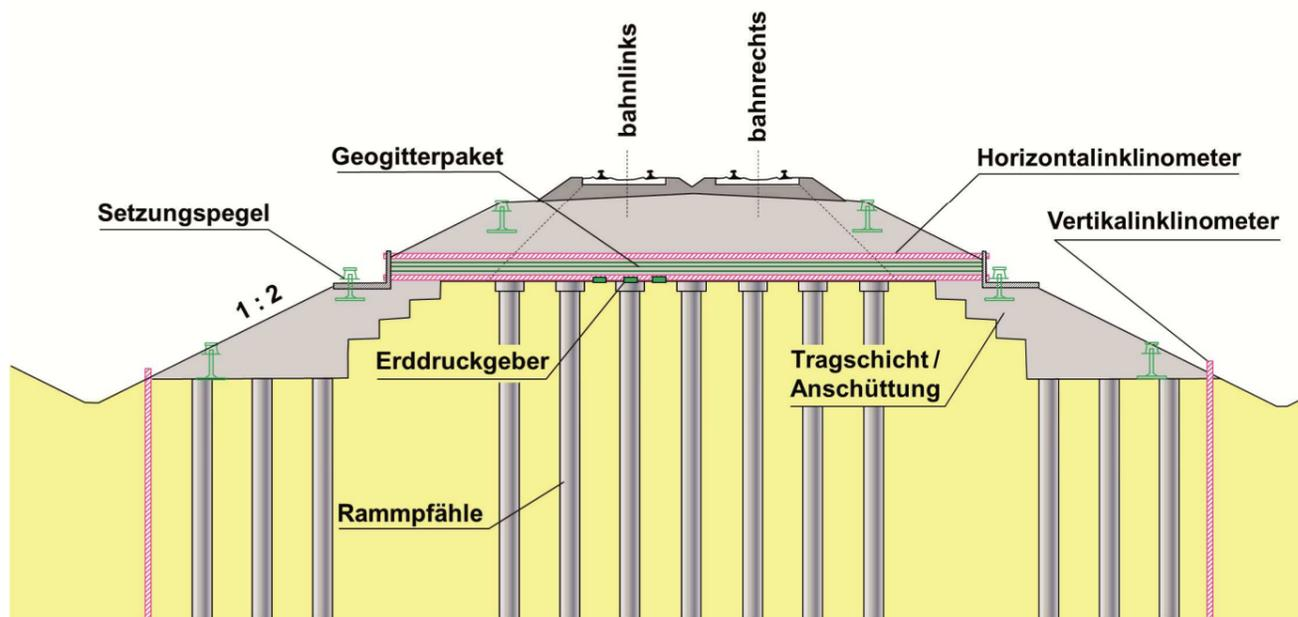
Bild 9: Beispiel Messquerschnitt im Moor 3
