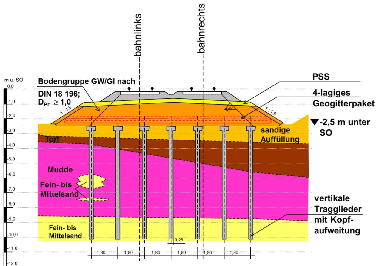
Bild 3: Regelquerschnitt der SGP-Bauweise aus der Entwurfsplanung
